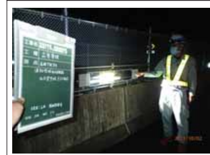
低位置照明アンカー引張試験 立会者 山本補助監督員
